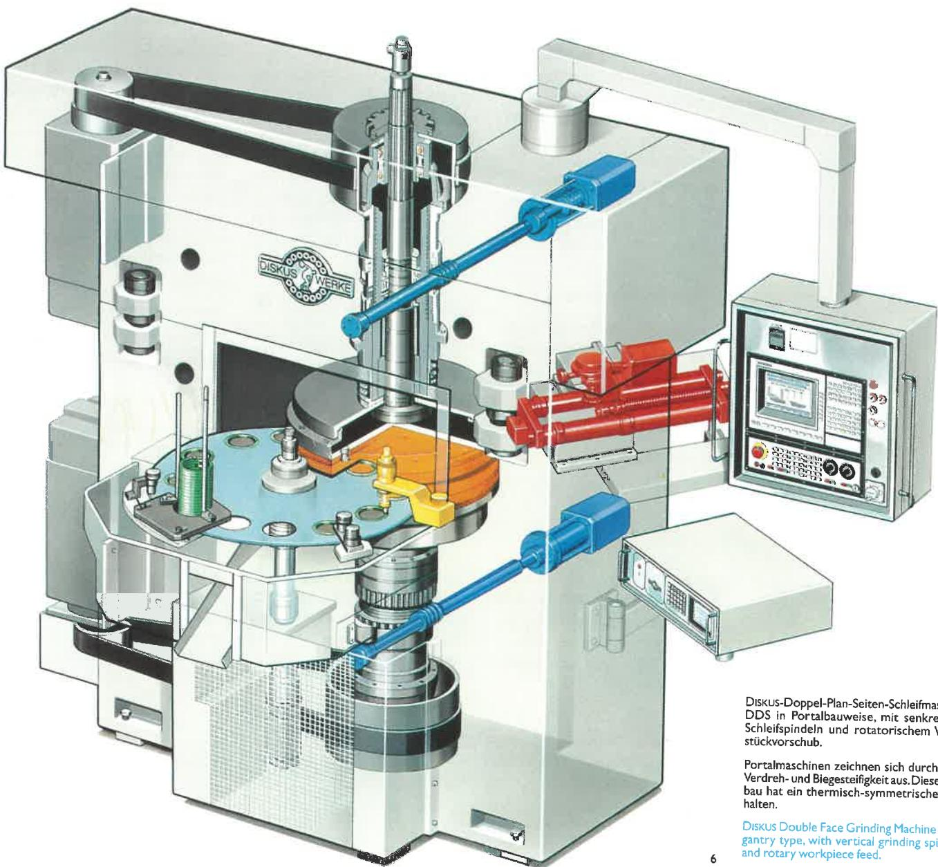
**DISKUS-Doppel-Plan-Seiten-Schleifmaschine DDS in Portalbauweise, mit senkrechten Schleifspindeln und rotatorischem Werkstückvorschub.**
