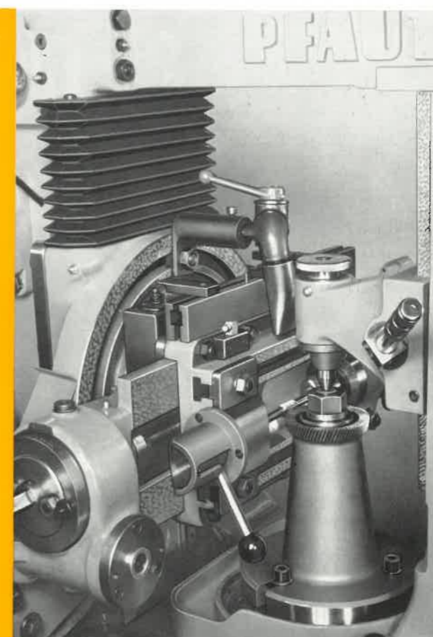
Bild 7 Schälen einer Schnecke mittels Schneidrad
