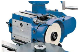
Schärfen eines Sägeblattes
