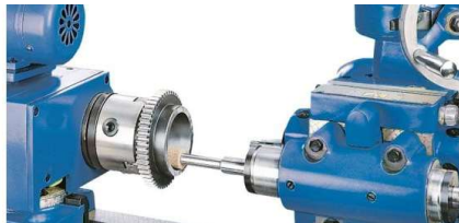
Innenrundscheifen mit hoher Drehzahl
