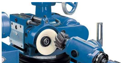
Stabile winkelbare Werkstückaufnahmen
